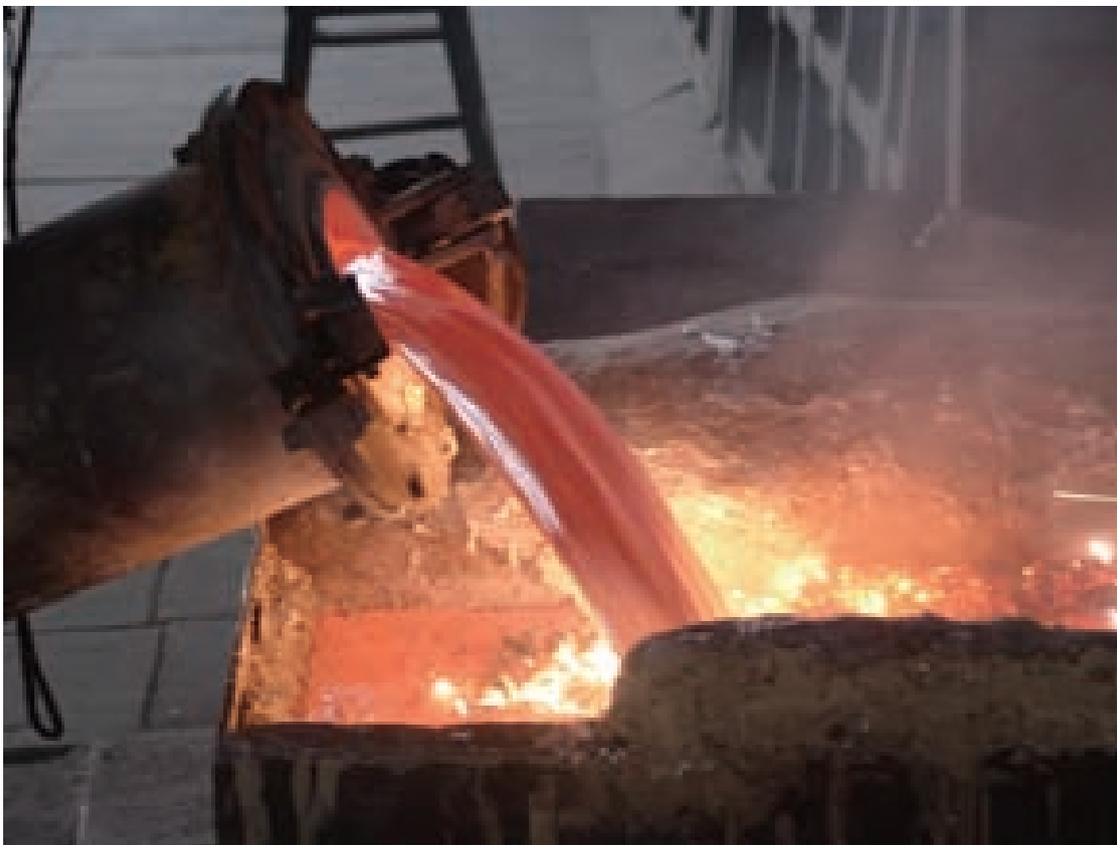
液態鋁合金是我們的主要產品，分別佔二零零八年、二零零九年、二零一零年及截至二零一一年三月三十一日止三個月我們銷售鋁產品所產生收入的約56.5%、61.5%、84.4%及76.6%。液態鋁合金為紅黃色高溫液體，其中主導金屬為鋁，其餘成分為鐵、銅、鋅、錳、硅、鎂及其他化學元素。液態鋁合金乃製造鋁產品的重要材料。我們以自行生產的電解鋁來生產液態鋁合金。
